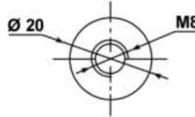
Anschluss: M8 Schraube oder M8 Poladapter
