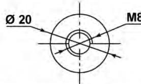
Anschluss: M8 Schraube oder M8 Poladapter
