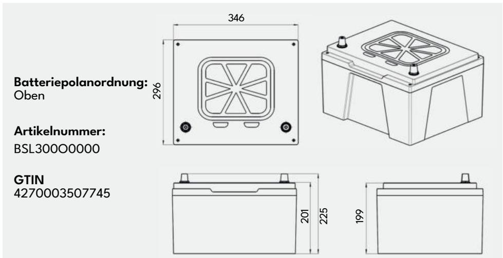
Hinweis: Die Darstellungen zeigen die Saftkisten mit eingeschraubten Batteriepoladaptern. Diese sind optional zu verwenden und liegen dem Lieferumfang bei.
