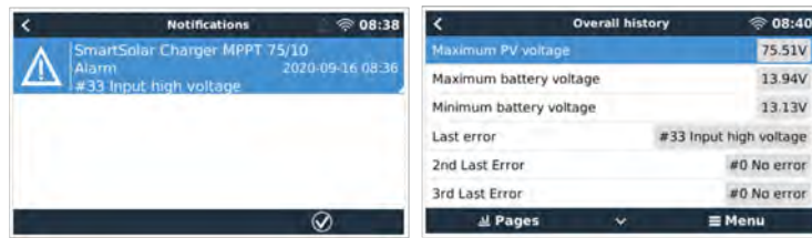
GX-Gerät mit Warmmeldeanzeige und historischen Fehlern.
