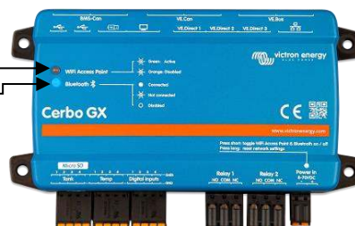
4 x ohmsche Tankeingänge, 4 x temp Eingänge, 4 x digitale Eingänge, Relais 1, Relais 2, Leistungs
