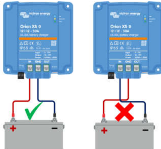
Beispiel für richtige und falsche (vertauschte) Batteriepolartät:
