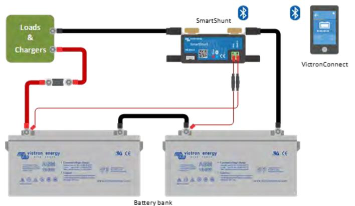
Messen des Mittelpunkts der Batteriebank
