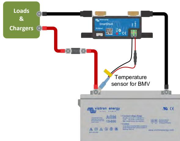
Tenere presente che, se si utilizza il sensore di temperatura, non sono necessari i cavi di alimentazione rossi in dotazione con lo SmartShunt. Il sensore di temperatura sostituirà tali cavi.
