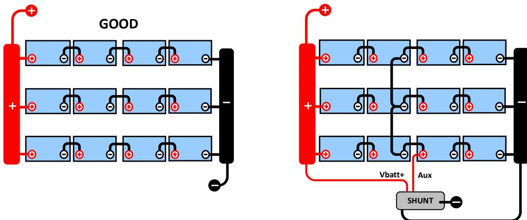
Bij een niet-gemonitorde accubank mogen de middelpunten niet met elkaar verbonden worden. Een defecte accubank kan onopgemerkt blijven en kan alle andere accu's beschadigen.
