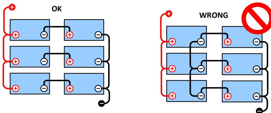
På grund av spänningsbortfall över de positiva och negativa kablarna är mittzonspänningarna inte identiska.
