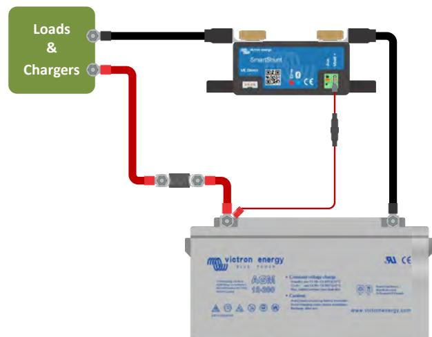
En cuanto se conecte el fusible en el cable, el Bluetooth del SmartShunt empezará a parpadear.
