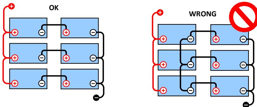
En raison de la chute de tension sur les câbles positif et négatif, la tension du point médian n'est pas identique.
