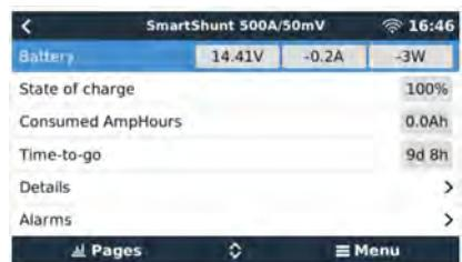
El SmartShunt puede conectarse a un dispositivo GX con un cable VE.Direct (referencia del artículo ASS03053xxxx). Puede encontrar los cables VE.Direct en longitudes de entre 0,3 y 10 metros y con conectores rectos y en ángulo. En lugar de usar un cable VE.Direct, el SmartShunt también puede conectarse al dispositivo GX con la interfaz VE.Direct a USB.
