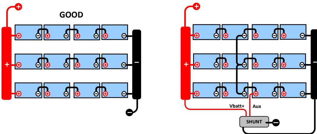
En una bancada de baterías sin control, los puntos medios no deberían estar interconectados, puesto que una bancada de baterías en malas condiciones podría pasar desapercibida y dañar a las demás baterías.
