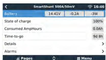
De SmartShunt kan worden aangesloten op een GX-apparaat met een VE.Direct-kabel, onderdeelnummer ASS03053xxxx. De VE.Direct-kabels zijn verkrijgbaar in lengtes variërend van 0,3 tot 10 meter en zijn verkrijgbaar met rechte of haakse stekkers. De SmartShunt kan in plaats van gebruik van een VE.Direct-kabel ook verbinding maken met het GX-apparaat via de VE.Direct-naar-USB-interface.
