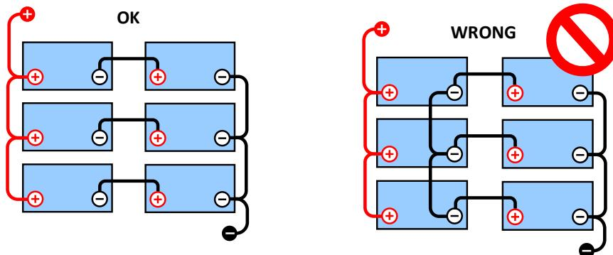
Door de spanningsval in de positieve en de negatieve kabels is de middenpuntspanning niet identiek.
