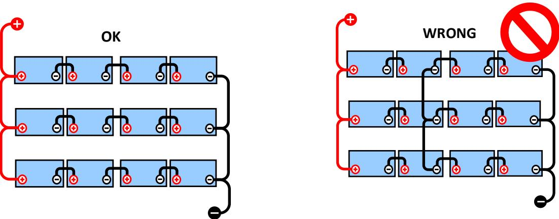
Door de spanningsval in de positieve en de nulkabels is de middenpuntsspanning niet identiek.
