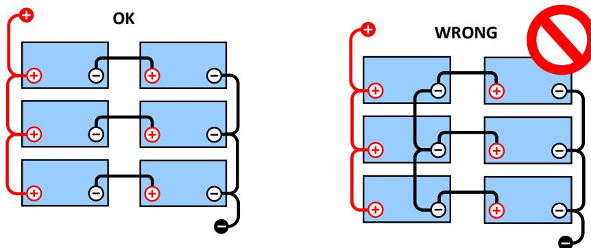
Debido a la caída de tensión en los cables positivo y negativo, las tensiones del punto medio no son idénticas.
