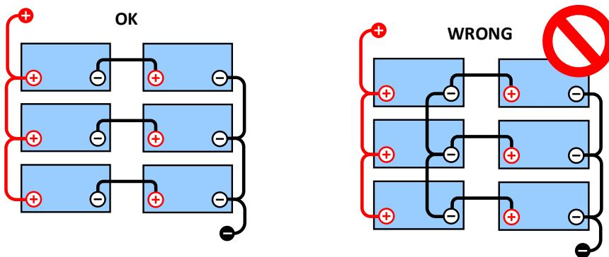
Devido à queda de tensão nos cabos positivo e negativo, as tensões do ponto médio não são idênticas.
