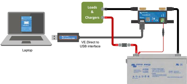
Für den Anschluss über USB benötigen Sie eine „VE.Direct to USB-Schnittstelle“, Teilenummer SS030530000. Verwenden Sie diese Schnittstelle, um den Computer mit dem SmartShunt zu verbinden.
