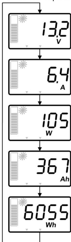
**Spannung:** Es wird die Spannung (Volt „V“) der Bord-Batterie angezeigt. Die Spannung der Starter-Batterie wird angezeigt, solange die Taste 1 für mindestens 3 Sekunden gehalten wird.
