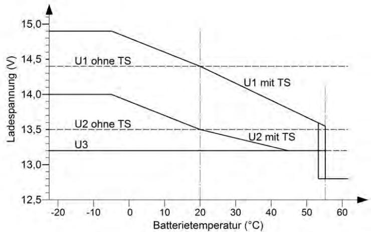
Universelle Ladekennlinie für Säure-Batterien nach DIN 57 510 / VDE 0510 zur Ladung und Ladeerhaltung von Versorgungs-(Bord-)Batterien.
